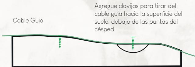
Agregue clavijas para tirar del cable guía hacia la superficie del suelo, debajo de las puntas del césped
