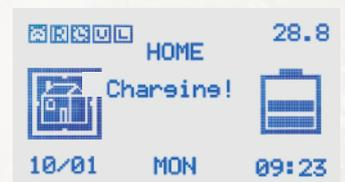
4. Cuando en el display se vea la siguiente imagen, el robot se está recargando y los sensores de lluvia fueron activados.
